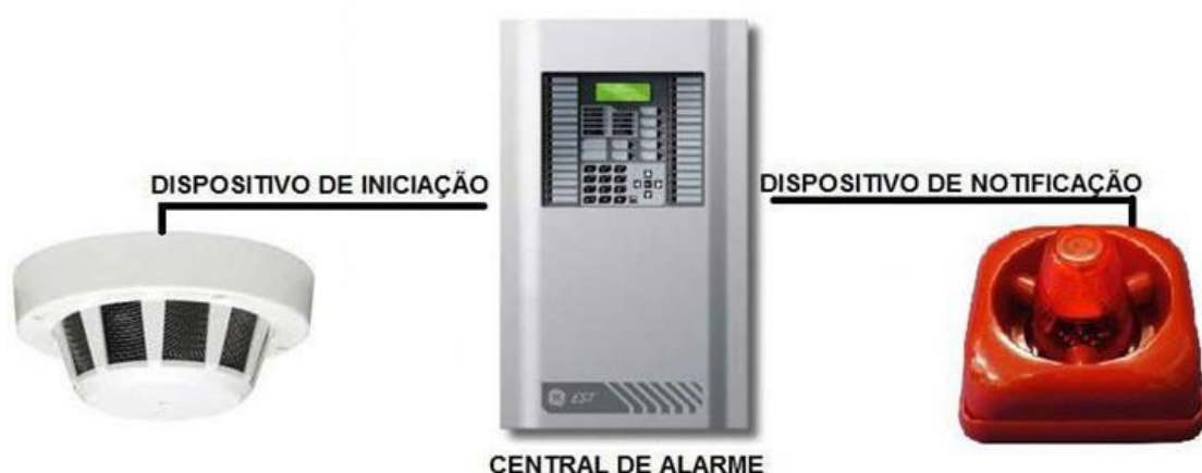
Sistema de detecção e alarme
