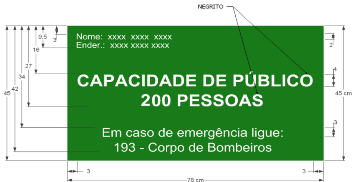
Figura 2 – modelo de sinalização tipo M2.
