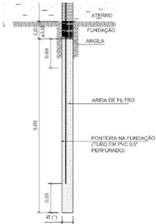
Figura 58. Esquema de instalação de um piezômetro na fundação. Fonte: COBA, S.A.
