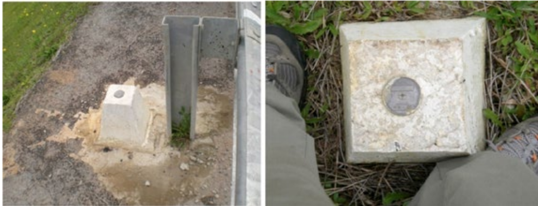
Figura 54. Marco topográfico com peça destinada ao encaixe de bastão (menor precisão que a utilização de miras de alta precisão estacionadas nos tacos de nivelamento). Fonte: COBA, S.A. / Banco de Imagens ANA
