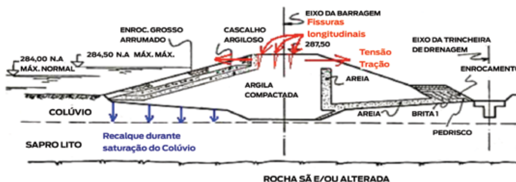
Figura 11. Fissuras longitudinais na crista da barragem de terra no rio Paranapanema, causada pelos recalques da camada de solo coluvionar poroso na fundação.
