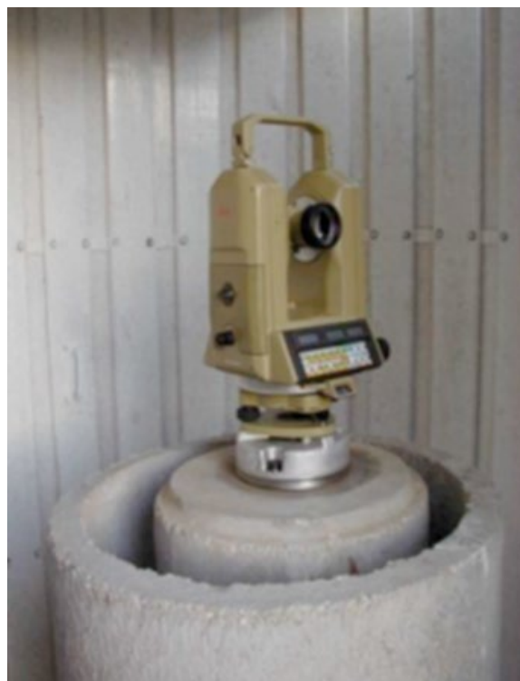
Figura 55. Marco de referência com teodolito. Fonte: COBA, S.A. / Banco de Imagens ANA
