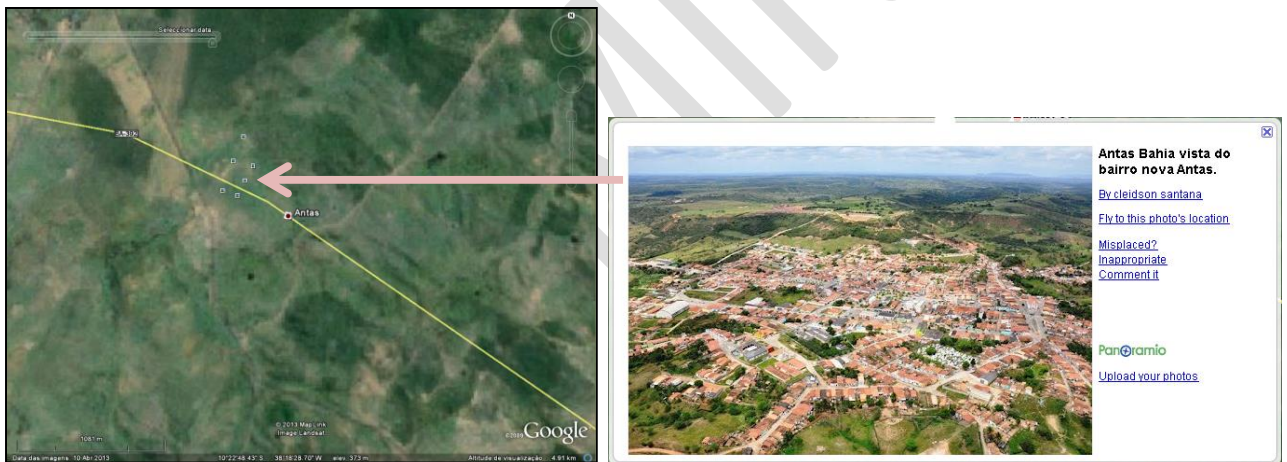
Figura 7 – Exemplo de imagem do Google-Earth para identificação dos elementos em risco no vale a jusante
