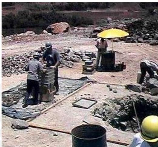
**Figura 24. Ensaio granulométrico *in situ* de enrocamento.**
